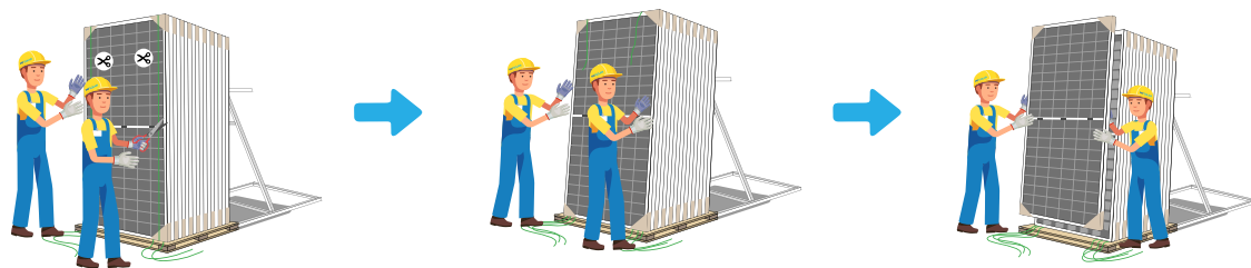
(6) 剪去纵向除内侧两根外的其余打包带，缓慢推动组件靠向支架
