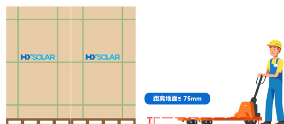
液压叉车周转叉齿高度要求示意图
