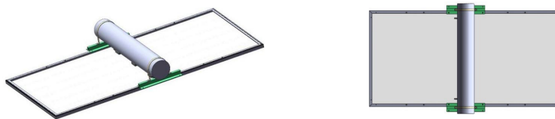
单轴跟踪系统组件安装示意图
